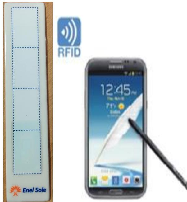
Per comunicare con l'etichetta **non è necessario alcun controllo esterno**. Inoltre il TAG IC è di **tipo passivo**, quindi per funzionare non deve essere usata alcuna batteria o sorgente di alimentazione esterna.
